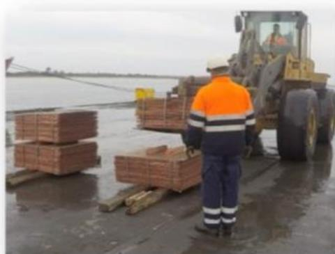
Para el levante de la mercancía y carga de camiones, se utilizarán las máquinas de tierra. Los camiones deberán venir provistos de madera, polines o cunas para depositar sobre ellos los paquetes.
